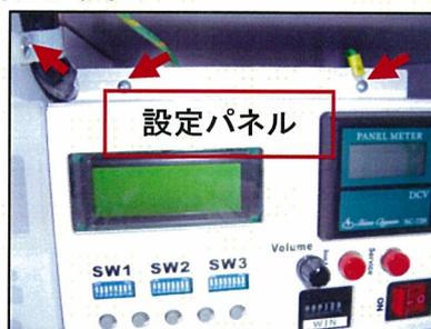
設定パネルの取付けネジ2本と配線クランプネジ1本を外します。
